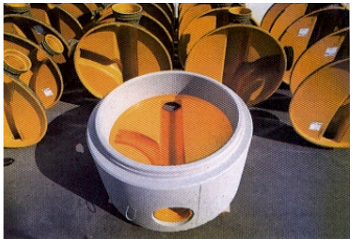
Insieme di rivestimenti in GFK prima di essere inglobati nel monoblocco in calcestruzzo.
